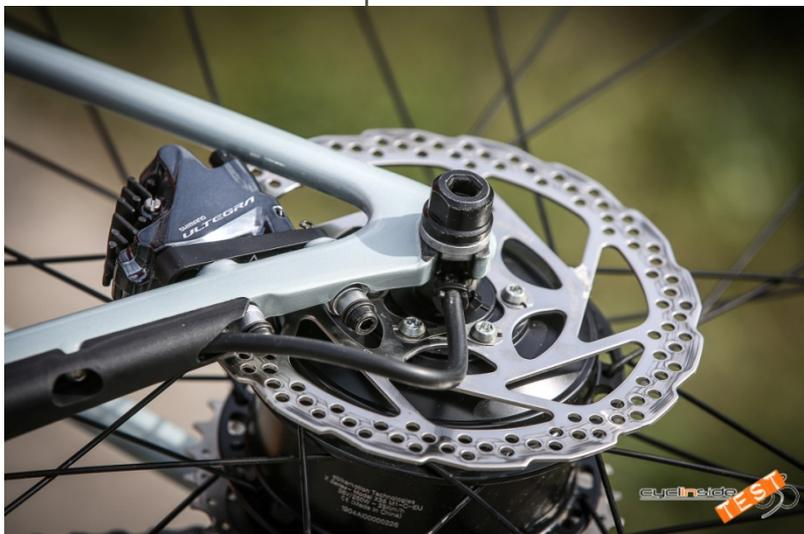
Il passaggio del cavo che va al motore posteriore è mimetizzato nel telaio.
