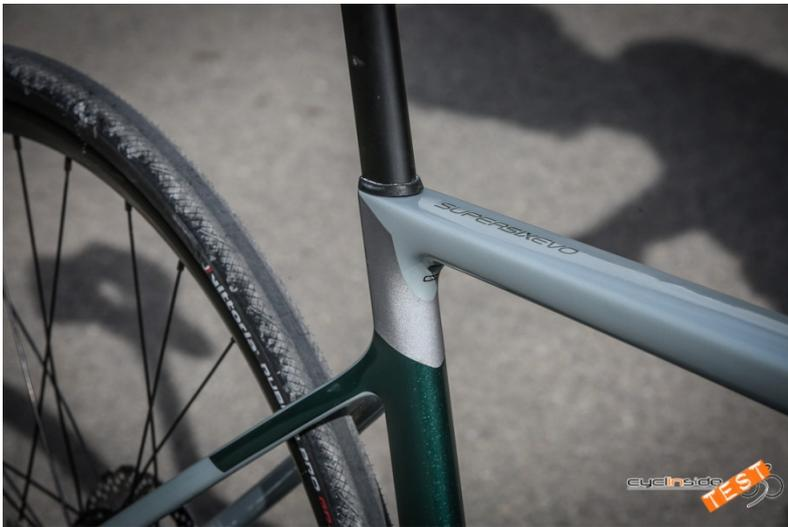
Materiale e design del telaio, dimensioni dei tubi, geometria e caratteristiche tecniche della Supersix Evo Neo sono infatti identici a quelli della “Evo” *muscolare*: come è usuale su questo segmento di e-bike il pacco batteria trova spazio all’interno del generoso tubo diagonale, mentre, per rendere il più possibile il telaio snello e filante, la motorizzazione è
